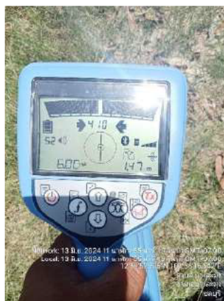
รูปที่ 2-14 การตรวจสอบแนวท่อของหน่วยสายตรวจเคลื่อนที่
